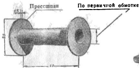
Рис. 60. Каркас для вторичной обмотки бобины.
